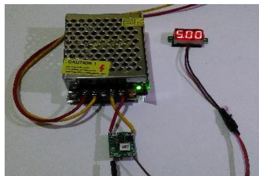
Gambar 14 Hasil pengujian rangkaian *power supply* dan *stepdown*
