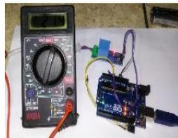
Gambar 16 Pengujian Sensor tegangan
