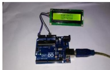
Gambar 22 Pengujian LCD 16x2
