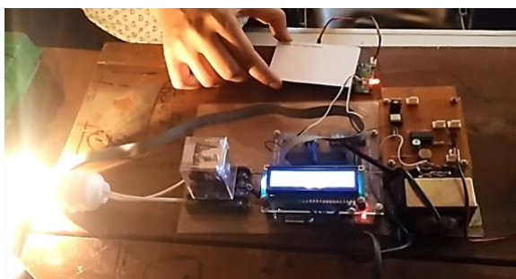
Gambar 4.10 Hasil uji driver dengan lampu AC
