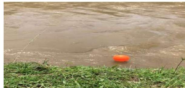
Gambar 3. Pengambilan data kecepatan air
