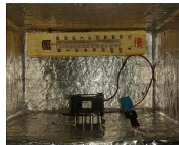
Gambar 9 validasi suhu dengan *thermometer*
