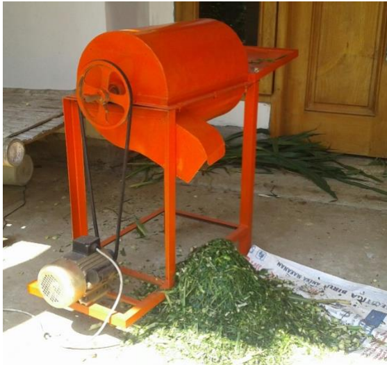
Gambar 3. Mesin pencacah rumput gajah
