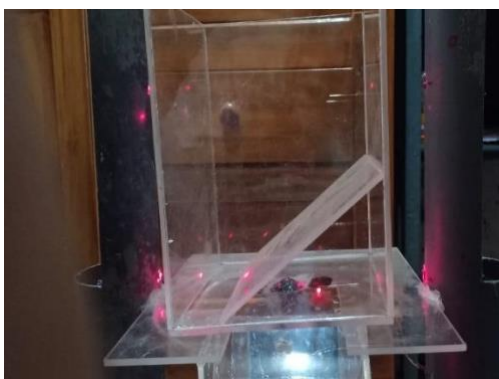
Gambar 2 Desain Tampungan Sekunder dan Sensor
