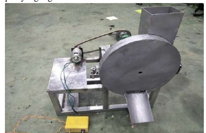
Gambar. Bahan menggunakan besi hollo 2 x 3 dan tebal plat yang digunakan 3 mm.
