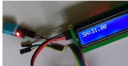
Gambar 3.1 pengujian sensor DHT11
