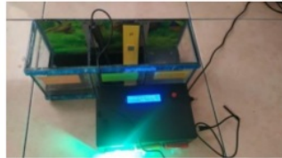
Gambar 4.6 Pengujian Sensor pH dengan Air Cuka/Asam
