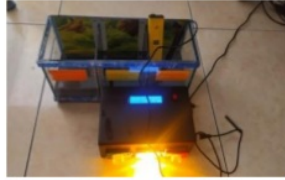
Gambar 4.7 Pengujian Sensor pH dengan Air Deterjen/ Basa
