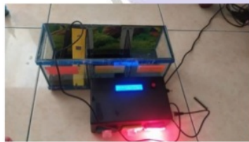
Gambar 4.5 Uji Coba Sensor pH dengan Air sungai
