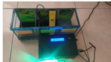
Gambar 4.6 Pengujian Sensor pH dengan Air Cuka/Asam
