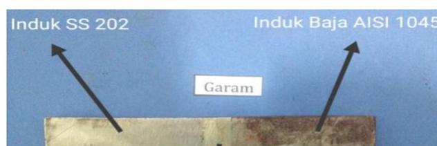
Gambar 3 : spesimen uji kekerasan pendingin air garam
