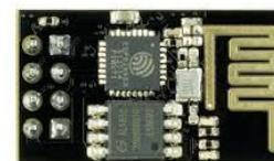
Gambar 6. *Modul ESP8266*
