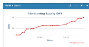
Gambar 28 Hasil tampilan web pengujian suhu pada ruang EWS
