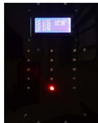
Gambar 8. Indikator hasil pengujian sensor LM35 kondisi 1
