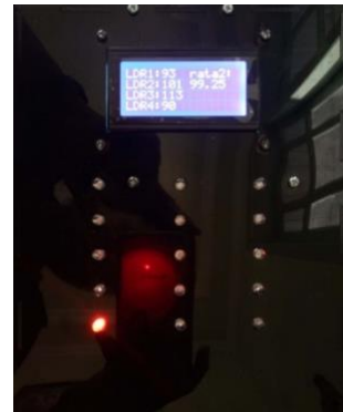
Gambar 5. Indikator hasil pengujian sensor LDR kondisi 1
