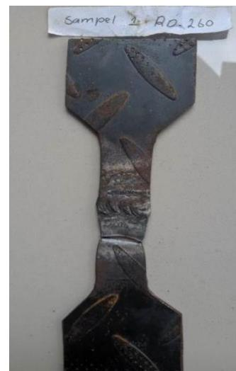
Gambar 1. Spesimen Sat Setelah Diuji Tarik
