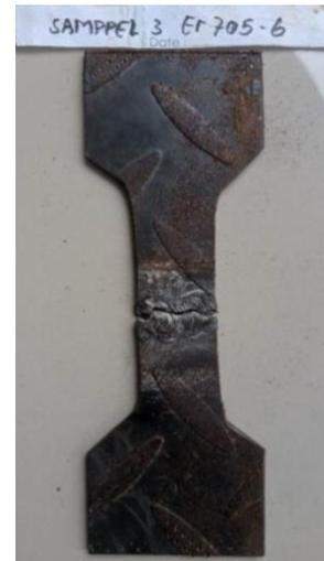
Gambar 3. Spesimen tiga setelah diuji tarik Specimen dengan bahan tambah Er705-6 lebih mudah putus karena jenis kawat ini jenis kawat solid atau tanpa flux, dari gambar di atas menunjukkan bahwa bahan tambah ini untuk kekuatan tariknya kurang bagus, dimana letak putus nya berada pada titik tengah pengelasan
