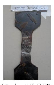
Gambar 1. Spesimen Sat Setelah Diuji Tarik
