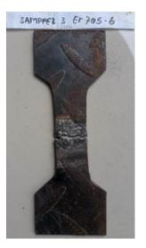
Gambar 3. Spesimen tiga setelah diuji tarik Specimen dengan bahan tambah Er705-6 lebih mudah putus karena jenis kawat ini jenis kawat solid atau tanpa flux, dari gambar di atas menunjukkan bahwa bahan tambah ini untuk kekuetan tarik nya kurang bagus, dimana letak putus nya berada pada titik tengah pengelasan
